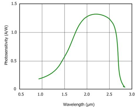
BV-C3101 は 1200nm から 2600nm に受光感度を持つ InGaAs センサを使用した短波長赤外専用のラインスキャンカメラです。感度を長波長へ拡げることにより、さらに広範囲の物質の検出を可能にします。BV-C3101 では使用するセンサにより BV-C3101R と BV-C3101S の 2 モデルあります。インターフェースはカメラリンク、レンズマウントは M52 マウントと C マウントから選択できます。(本商品は受注生産品です)
